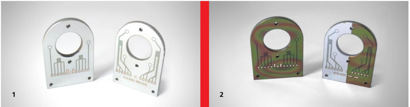
**1** Unterlegscheibenartige Sensorsysteme mit unterschiedlichen Sensoranordnungen auf der Oberfläche gehärteter Stahlsubstrate.
