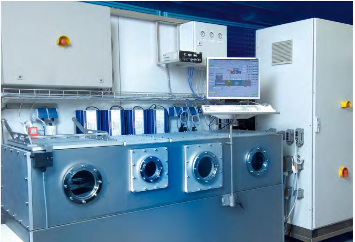
Abb. 4: VUV-Excimeranlage des Fraunhofer IFAM zur Aktivierung und Beschichtung von Oberflächen.
