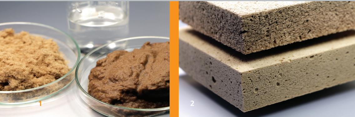
1 Die Ausgangsmaterialien zur Holzschäumherstellung: Holzfasern und Wasser. Vorne rechts: Die Suspension vor dem Aufschäumen.
